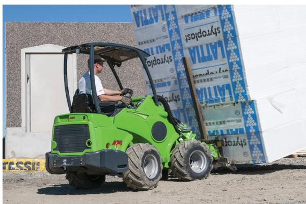
(\*) A carga é medida a 400 mm do engate do acessório, incluindo o peso de fixação (70kg) e contrapesos.
