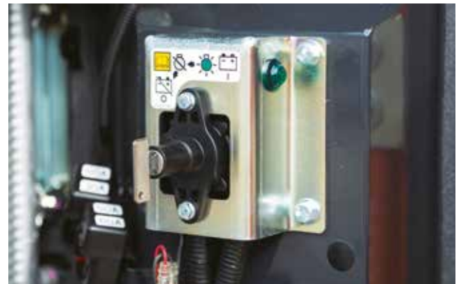
O interruptor para desligar a bateria permite fazer a manutenção em segurança.
