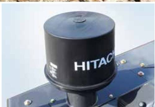
Menos manutenção e limpeza do filtro graças ao pré-filtro opcional.
