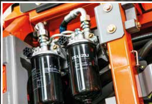
O filtro principal de combustível é mais fácil de substituir.
