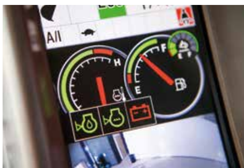
O monitor LCD mostra o estado e as definições da máquina.
