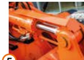
Barra de proteção do cilindro do balde.
