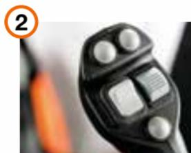
Alavanca auxiliar com comando rotativo para os modelos ZW150-6 a ZW250-6.
