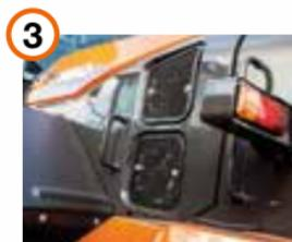
Proteção do radiador para os modelos ZW150-6 a ZW250-6.
