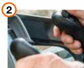
A alavanca auxiliar tem um interruptor proporcional que facilita o controlo dos acessórios dianteiro.
