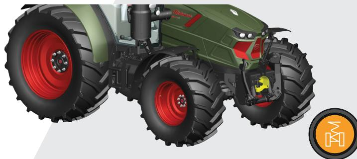
Suspensão do eixo frontal de dois cilindros; maior conforto e capacidade operacional na estrada e em campo aberto. A ativação faz-se na cabina, com um simples toque num botão.
