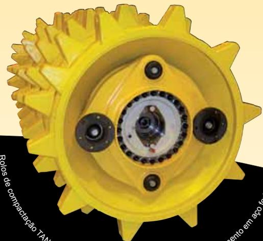
Roos de compactação TANA – 2 rolos a toda a largura com dentes de esmagamento em aço forjado
