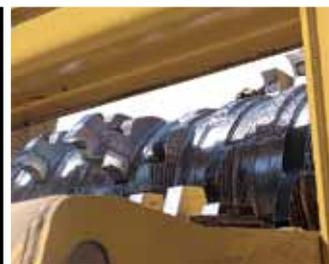
Superfície soldada robusta para maior vida útil do tubo do rotor.
