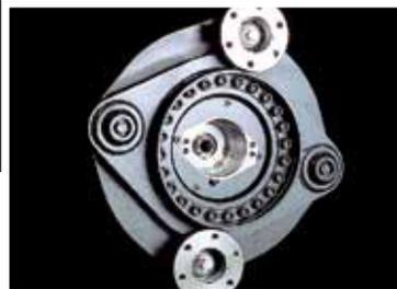
Estrutura articulada da transmissão do rotor (patenteada) com proteção das engrenagens.
