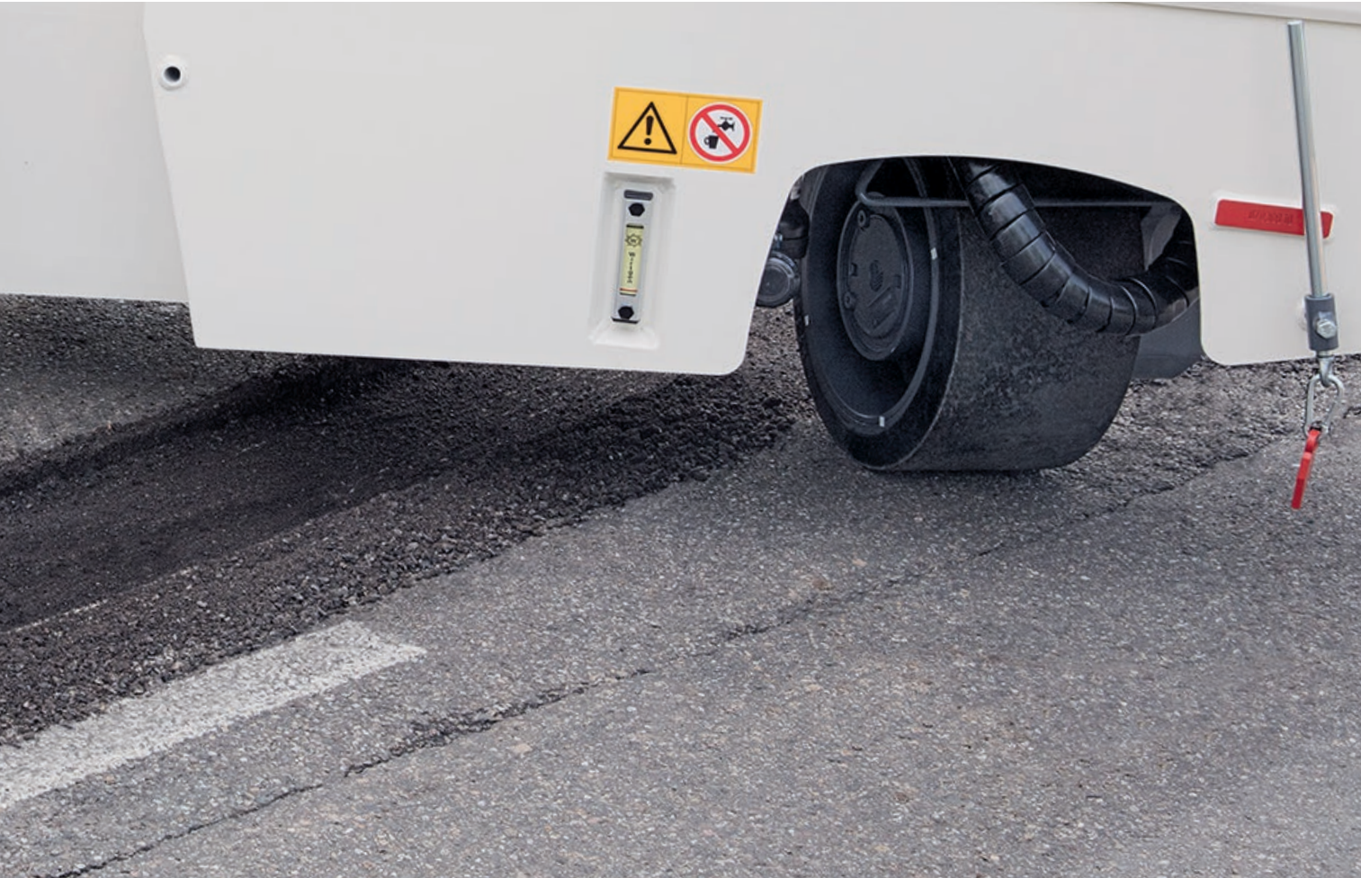
01 - 02 O acionamento de deslocamento com regulagem eletrônica permite a fresagem precisa - como em torno de estruturas rodoviárias.
