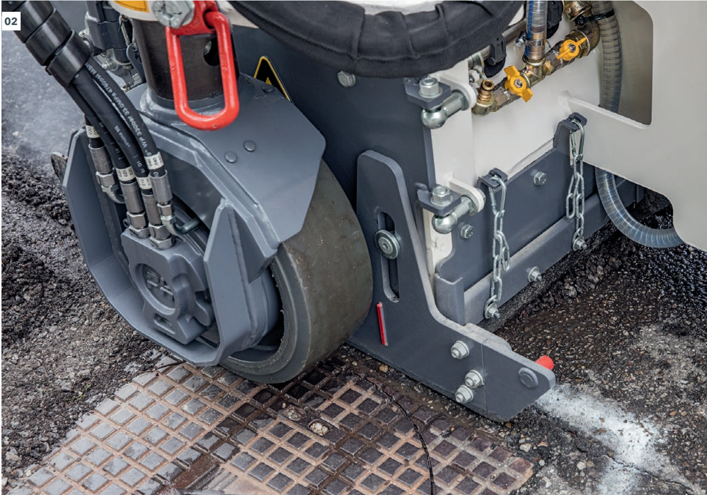
01 - 02 O acionamento de deslocamento com regulagem eletrônica permite a fresagem precisa - como em torno de estruturas rodoviárias.
