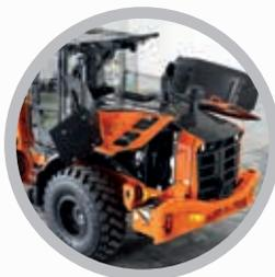
A manutenção é rápida e simples devido ao acesso melhorado aos componentes e à utilização de radiadores com sistema antiobstrução.
