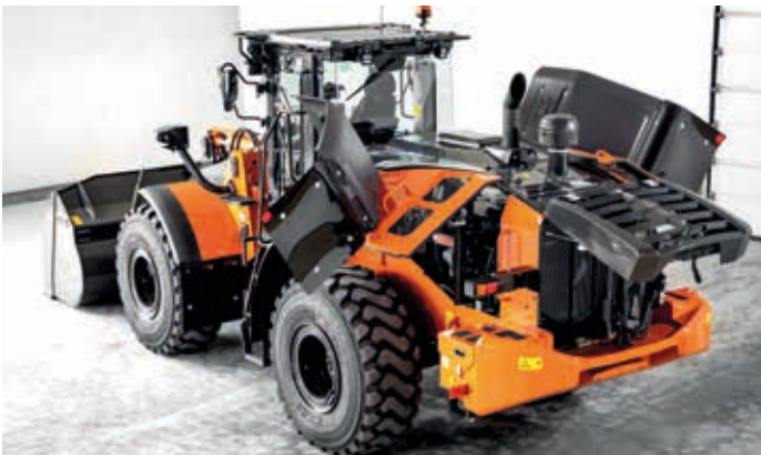
A tampa do motor permite um acesso cómodo para inspeções diárias.
