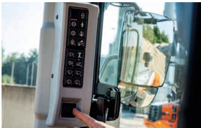
Os espelhos retrovisores de ajuste elétrico melhoram a visibilidade traseira.
