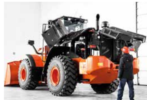
Fácil acesso ao compartimento do motor.
