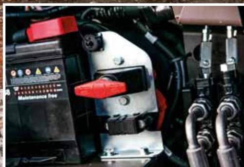
O interruptor de corte de corrente da bateria facilita a manutenção.
