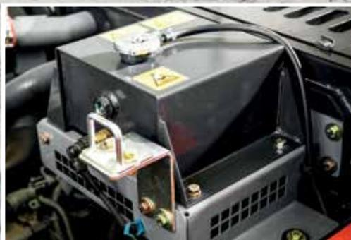
O vaso de expansão impede o superaquecimento do motor.
