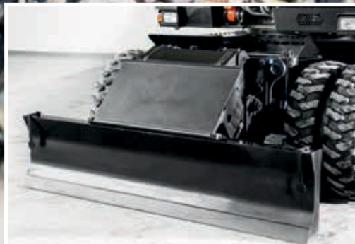
A proteção de grandes dimensões do cilindro da lâmina, garante maior resistência e robustez.
