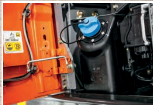
Injeção de ureia nos gases de escape para reduzir as emissões.
