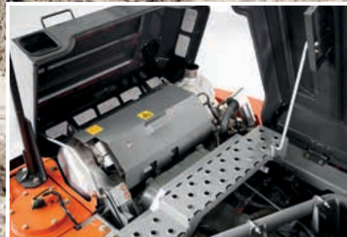
O sistema SCR reduz os níveis de emissões e de ruído.
