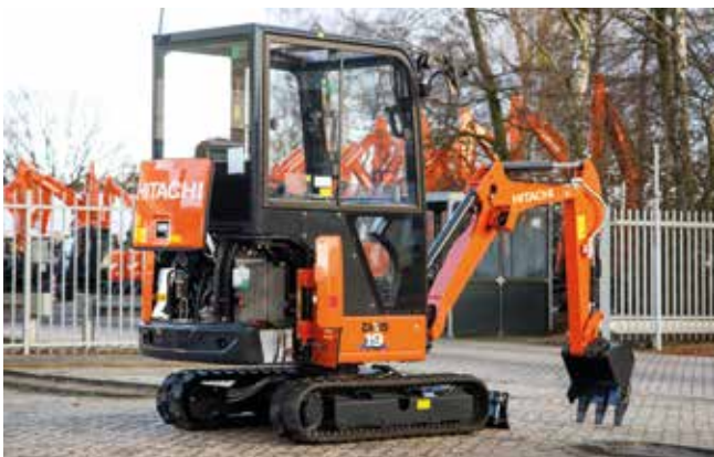
A tampa do motor abre com um movimento vertical, ideal em espaços apertados.
