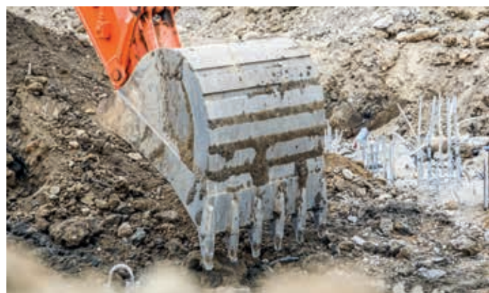
Os bicos e suportes originais Hitachi trazem bicos autoafiáveis, lâminas e adaptadores que garantem uma maior qualidade de trabalho e robustez.
