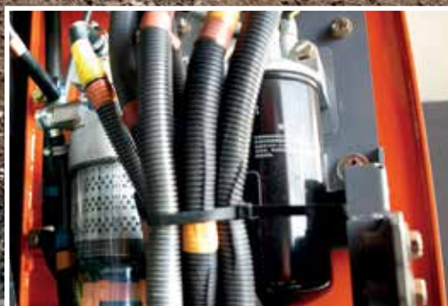
O filtro principal de combustível é mais fácil de substituir.
