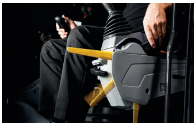
A alavanca de segurança dos comandos pilotados oferece maior segurança na cabina.
