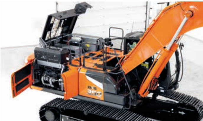
A tampa do motor com amortecedores (ZX300/ZX350) facilita o acesso e a segurança na manutenção diária da escavadora.
