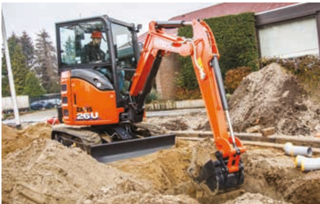
A frente de escavação da miniescavadora Hitachi tem uma proteção para o cilindro da lança, para maior segurança e vida útil.
