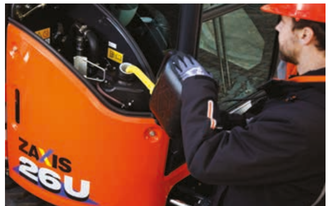
Espaço disponível na zona da tampa do depósito de combustível para facilitar o reabastecimento.
