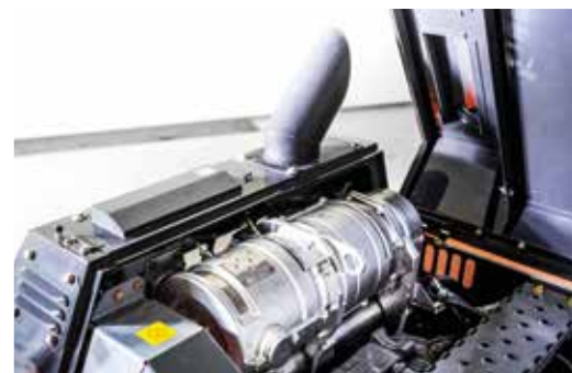
O sistema SCR reduz as emissões poluentes e o ruído.
