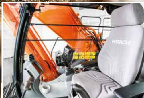
Redução de ângulos mortos melhora a visibilidade a partir da cabina.
