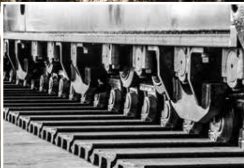
Um maior número de protecções dos rastros aumenta a vida útil dos elos.
