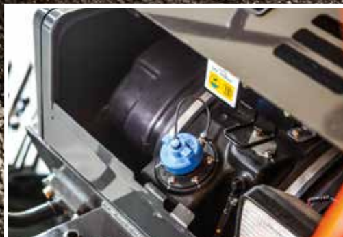
Injecção de ureia nos gases de escape para reduzir as emissões.
