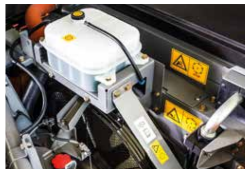
O copo de expansão impede o sobreaquecimento do motor.
