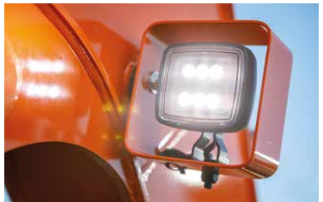
As luzes LED têm uma vida útil mais longa do que as alternativas de halógeno.
