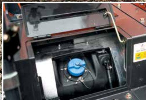
Injecção de ureia nos gases de escape para reduzir as emissões.
