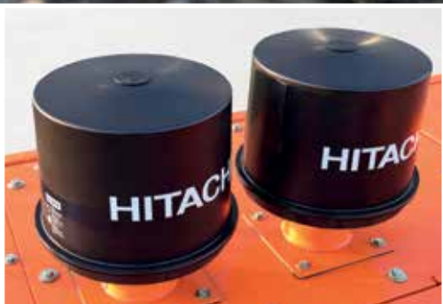
Menos manutenção e limpeza do filtro graças ao pré-filtro opcional.
