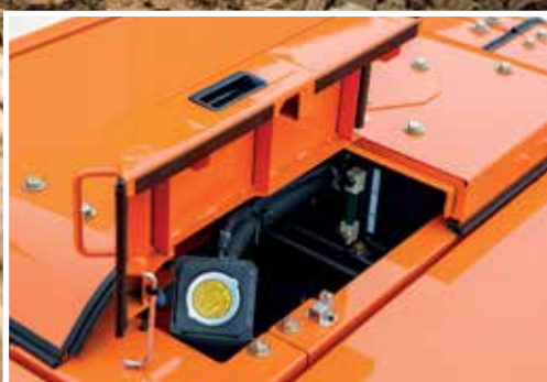
O depósito de expansão impede o sobreaquecimento do motor.
