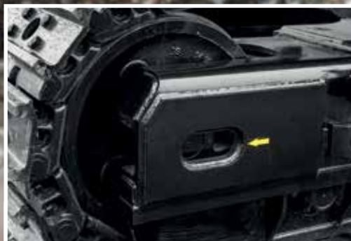
O reforço da proteção do motor e da roda de guia dos rastros protege o equipamento.
