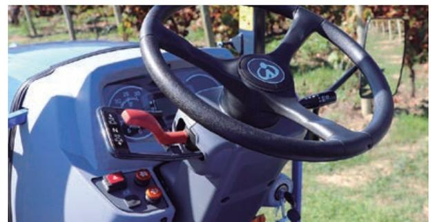
Inversor eletro-hidráulico com alavanca colocada sob o volante do lado esquerdo, com um acesso fácil.
