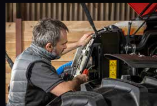
O acesso ao conjunto de refrigeração é fácil, para facilitar as operações de limpeza e manutenção.
