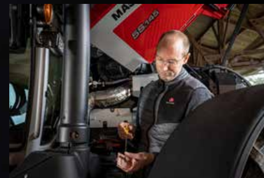
O design do capot mais estreito ao centro e do eixo dianteiro tornam fácil aceder à vareta do óleo do motor e ao filtro de óleo.
