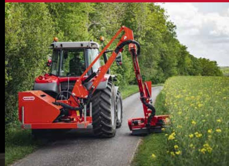
A cabina Panorâmica da Série MF 6S oferece uma visibilidade desobstruída do lado direito, permitindo uma utilização segura e eficiente de qualquer equipamento montado lateralmente. O amplo vidro em policarbonato é extremamente resistente e protege os operadores contra quaisquer objetos que possam ser projetados durante o trabalho.
