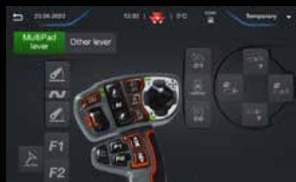
◀ **Atribuição do interruptor do MultiPad ISOBUS** – Os acessórios ISOBUS podem ser controlados diretamente ao utilizar a alavanca do MultiPad. Ter todos os comandos (do trator e do acessório) agrupados no mesmo sítio é muito mais prático do que ter de instalar e utilizar outros ecrãs e alavancas no trator.
