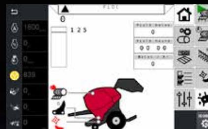
◀ **ISOBUS para controlo total dos acessórios** – O sistema ISOBUS permite que o sistema de controlo do fabricante de um acessório seja apresentado no ecrã do terminal, poupando tempo e dinheiro aos proprietários e operadores, sem necessidade de instalar mais monitores na cabina. Basta ligar o cabo do acessório à entrada ISOBUS do trator para o sistema carregar automaticamente os menus de utilização e apresentá-los no ecrã. O ISOBUS do MF 6S aplica-se à certificação AEF.
