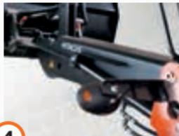
A válvula de segurança evita a descida do braço de elevação se existir uma fuga nas manguerias hidráulicas.
