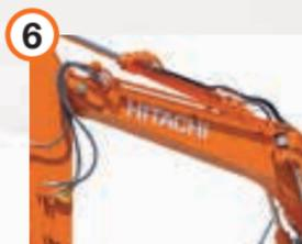
Circuito auxiliar para acessórios exigentes (martelos, cabeças processadoras, tesouras, etc.).
