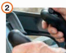
Alavanca auxiliar com comando rotativo proporcional, para um controlo fácil e eficiente do acessório.
