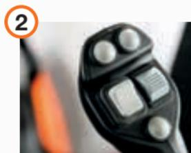
Alavanca auxiliar com comando rotativo proporcional (ZW150-6 a ZW250-6).
