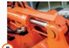
Barra de proteção do cilindro do braço.
