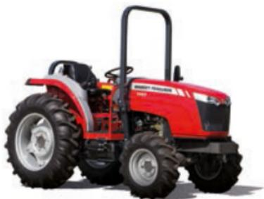
Os tratores compactos MF 1700 têm motores de três e quatro cilindros, regulação e controlo elétrico da velocidade e inversor mecânico sincronizado. Com uma excelente relação custo/eficiência são ideais para horticultura, municípios, etc.
